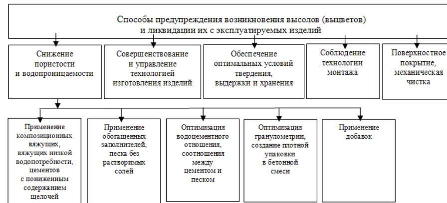
Рис. 5. Способы предупреждения возникновения высолов (выцветов) и ликвидации их с эксплуатируемых изделий
