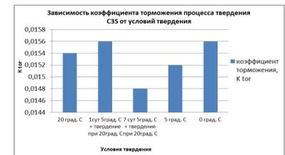
Рис. 9, 10, 11 Зависимость начальной скорости, коэффициента торможения и коэффициентов а и b процесса твердения C<sub>3</sub>S от условий твердения
