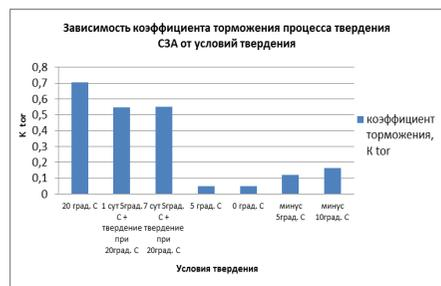
Рис. 12, 13, 14 Зависимость начальной скорости, коэффициента торможения и коэффициентов а и b процесса твердения C3A от условий твердения
